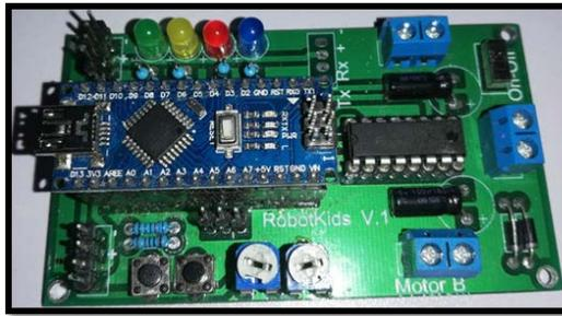
Figura 5 Tarjeta terminada.
