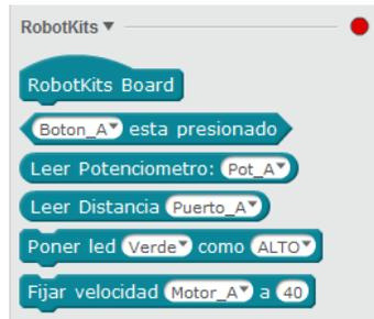
Figura 12 Bloques para la tarjeta *RobotKids*.
