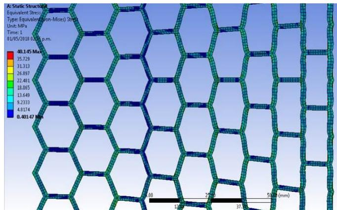
Figura 18 Esfuerzos equivalentes de espécimen de PLA/PBS sometido a deformación uniforme de  $\epsilon_x = 0.1286$  en dirección  $x$ .
