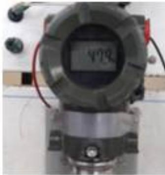
Figura 2 Transmisor indicador de presión marca Yokogawa.
