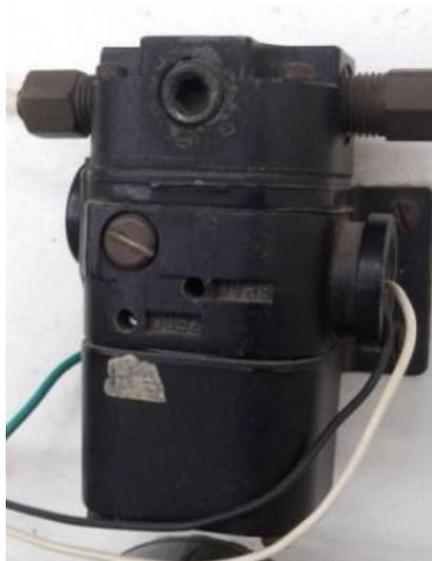
Figura 4 Convertidor de corriente a presión marca Moore.
