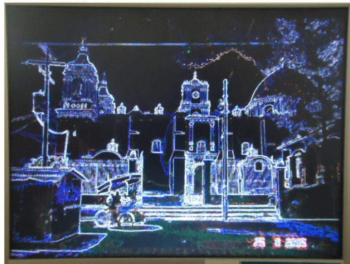
Fig. 18. Gradiente en las direcciones x y.
