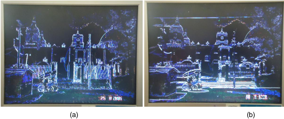
Fig. 17. Gradiente de una imagen: (a) en dirección x y (b) en dirección y.
