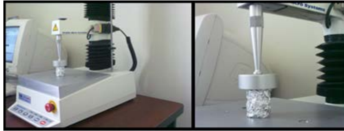
Fig. 2. Máquina Analizadora de textura T.A.X.T. de 300 N.
