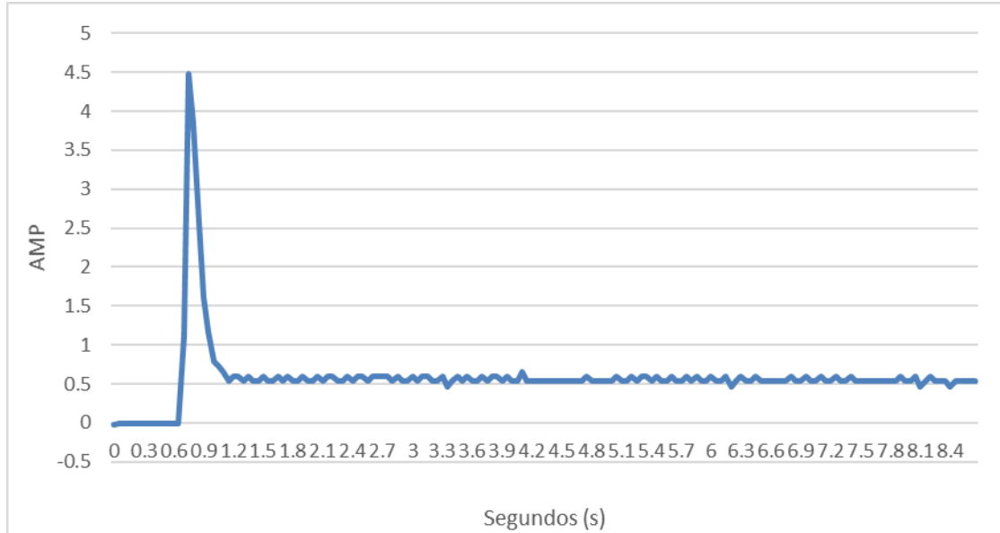
Fig. 12. Gráfica de corriente del motor de CD.
