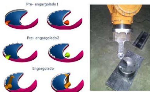
Fig. 19. Robots ABB en el proceso de *Roll Hemming*.
