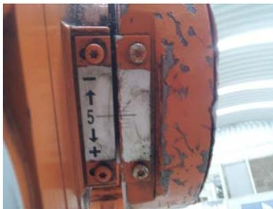
**Fig. 10. Joint 5 posicionado en su marca de calibración.**
