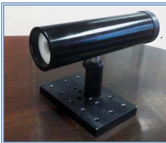
**Fig. 2. Imagen del prototipo de medidor de potencia óptica.**
