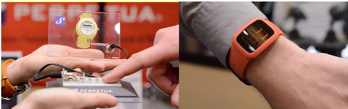
Fig. 11. Termoelectricos en dispositivos de uso común.
