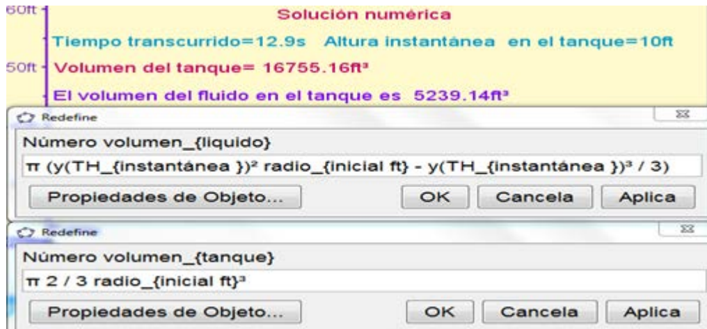
Fig. 20 Descripción mediante la herramienta de inserta texto del tiempo transcurrido, altura instantánea en el tanque, cálculo del volumen del tanque y volumen instantáneo del fluido.
