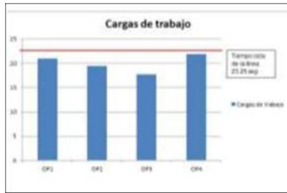
Figura 3. Cargas de trabajo de la línea con la sección de inspección de fisuras al final de la línea. Se observa una carga más uniforme entre los operadores.
