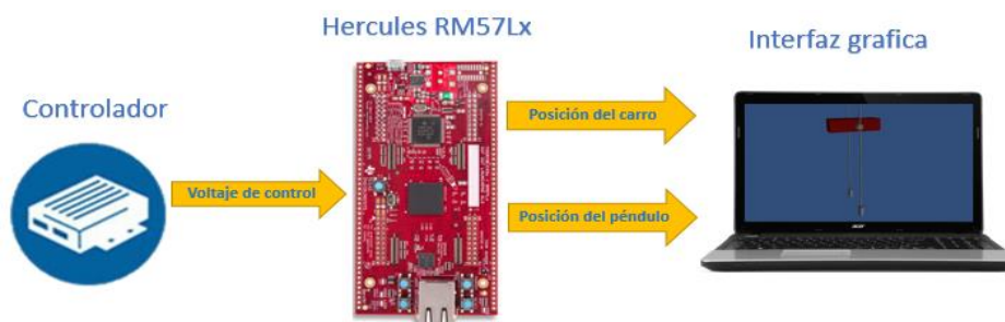
Figura 3 Entradas y salidas del simulador HIL.
