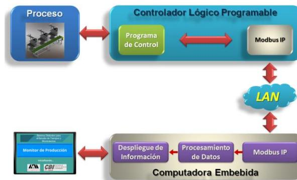
Figura 2 Diagrama de bloques del sistema desarrollado.
