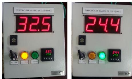
Figura 10 Vistas frontales del monitor de temperatura construido.
