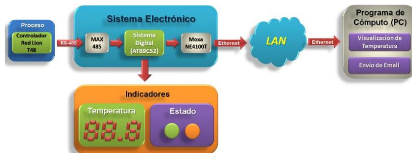
Figura 3 Diagrama de bloques del sistema desarrollado.
