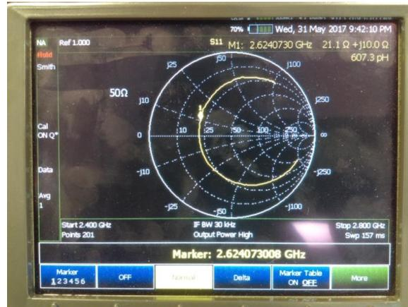
Figura 9 Impedancia de entrada de antena de parche fractal tipo E dos iteraciones.
