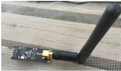
Figura 4 Antena de transmisión.
