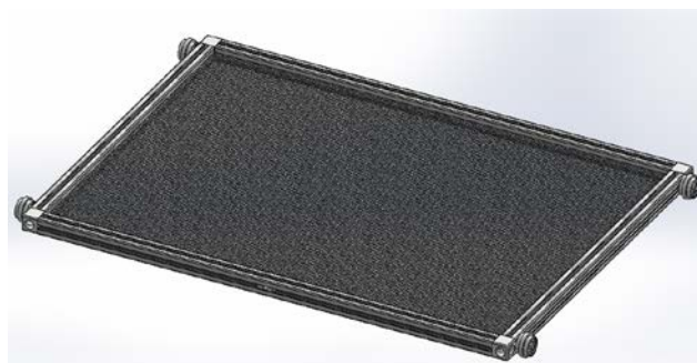
Figura 4 Malla para la tela y atenuar la intensidad del láser.
