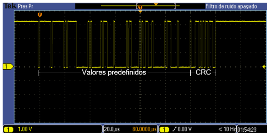
Figura 4 Paquete de instrucción obtenido después del cálculo del FPGA.
