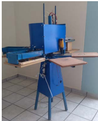
Figura 5 Versión 1.0 de la máquina de serigrafía automatizada.
