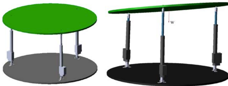
Figura 6 Diseño del robot paralelo 3-RPS en CAD.
