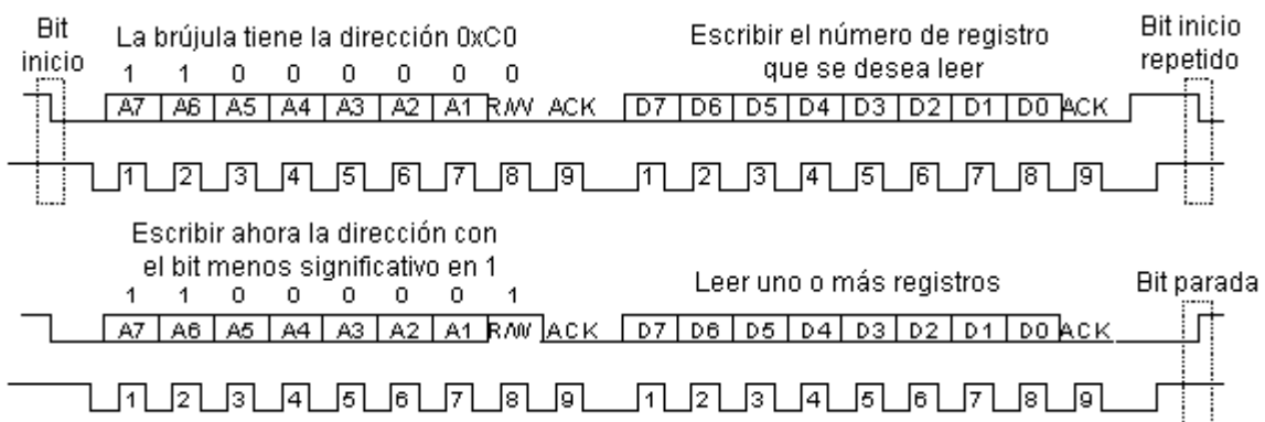
Figura 4 Trama de comunicación del bus I2C.
