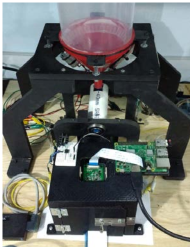
Figura 6 Sistema de selección de granos de café tostado.
