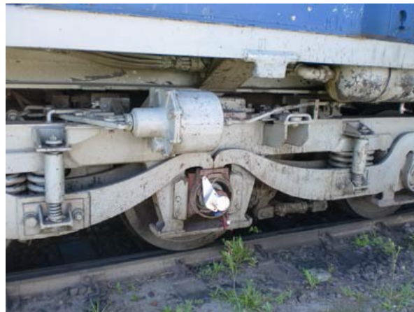
Figura 14 Tercer prototipo colocado en la rueda de la locomotora.
