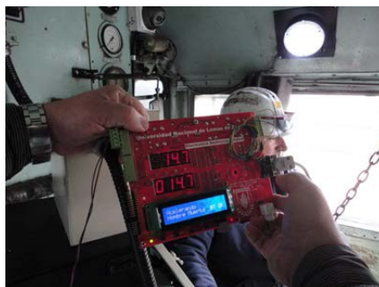
Figura 12 Recepción remota de la señal de velocidad de desplazamiento.
