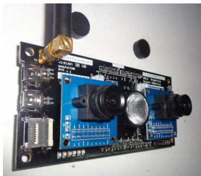
Figura 17 Módulo de captura de vídeo binocular versión VR 3D y radar SAR final.
