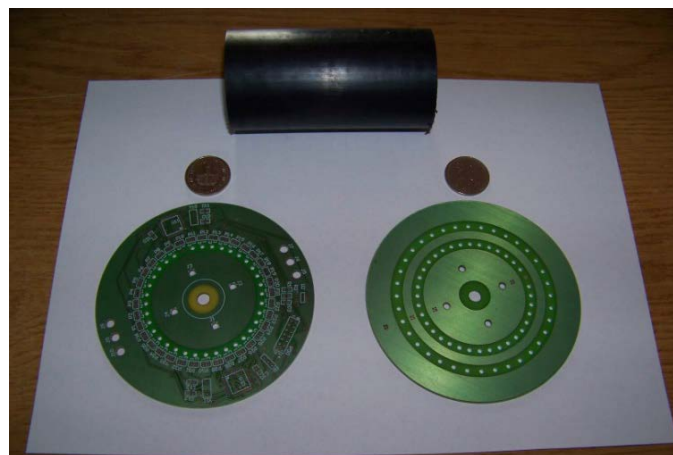
Figura 7 Plaqueta de circuito impreso (izquierda) y plaqueta porta perforaciones e imanes.
