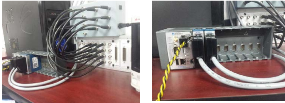
Figura 11 Conexión entre la tarjeta dSPACE® y CompactRIO®.
