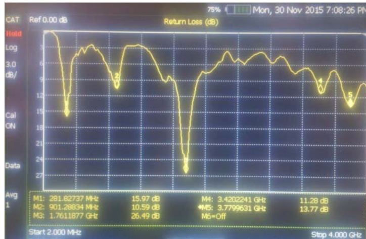
Figura 9 Frecuencias de resonancia medidas experimentalmente.
