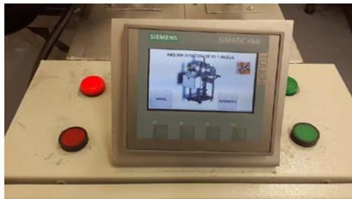
Figura 12 Interfaz HMI para manejo de la máquina mezcladora.
