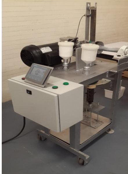
Figura 13 Máquina mezcladora de poliestireno y arcilla.
