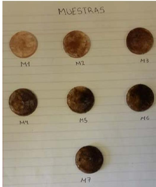
Figura 14 Muestras de Poliestireno-arcilla obtenidas con la máquina.
