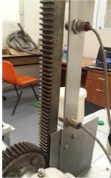
Figura 11 Mecanismo Cremallera-piñón para controlar la inyección.
