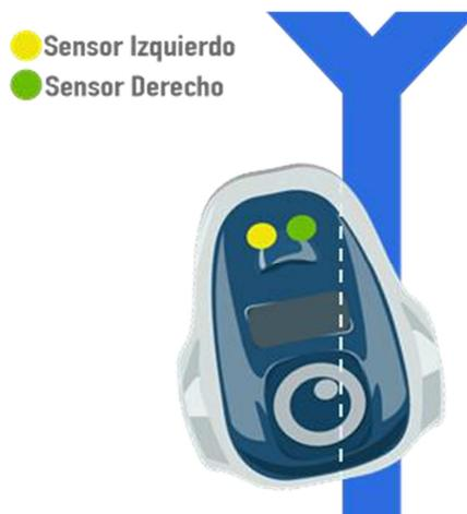
**Fig. 7. Ambos sensores de línea sensando blanco.**
