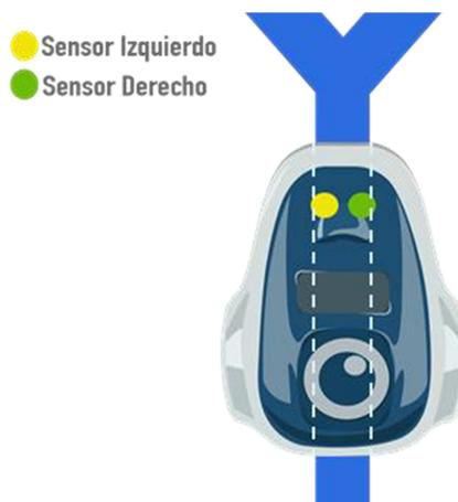
**Fig. 8. Ambos sensores de línea sensando azul.**
