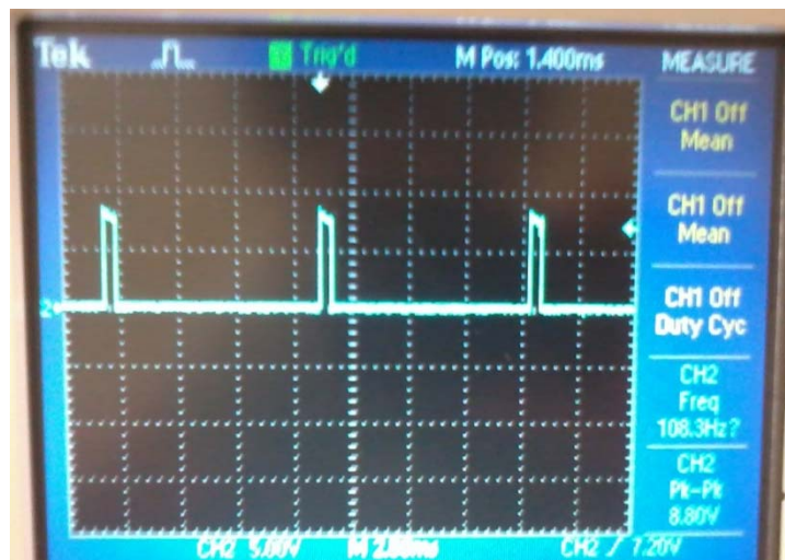
Fig. 9. Señal en el osciloscopio de los pulsos de 60 ms.
