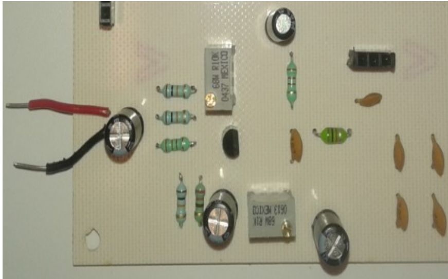
Fig. 7. Desarrollo del oscilador Clapp en PCB.
