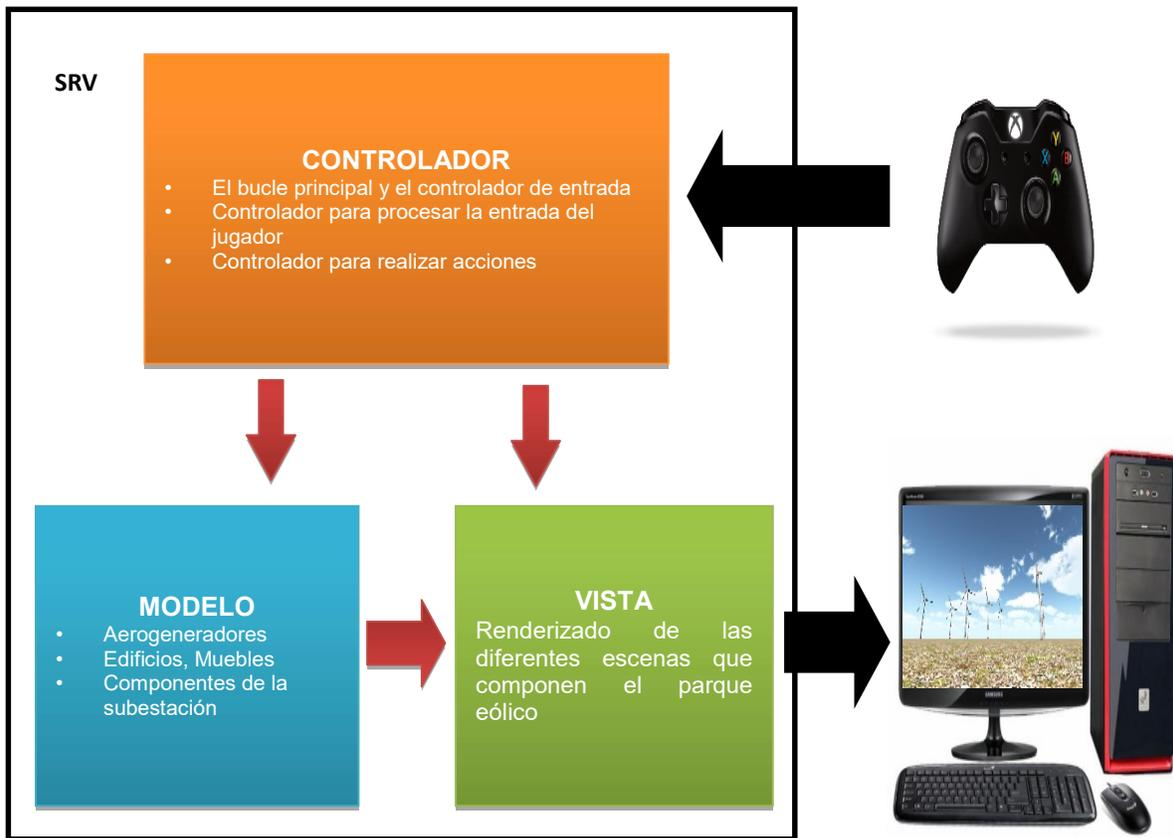
Fig. 1. Patrón MVC para el SRV propuesto.
