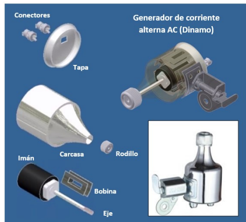
Figura 4. Elementos de la Dinamo.
