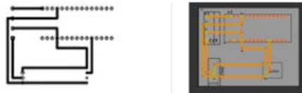
Figura 9 Diseño del PCB del módulo de sensores y Arduino nano.
