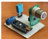
Figura 10 Módulo de sensores y Arduino nano.
