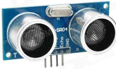
Fig. 3. Sensor ultrasónico HC-SR04.
