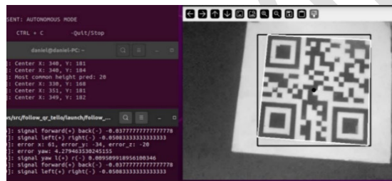
Figura 5 Sistema de aterrizaje autónomo integrado ejecutándose.
