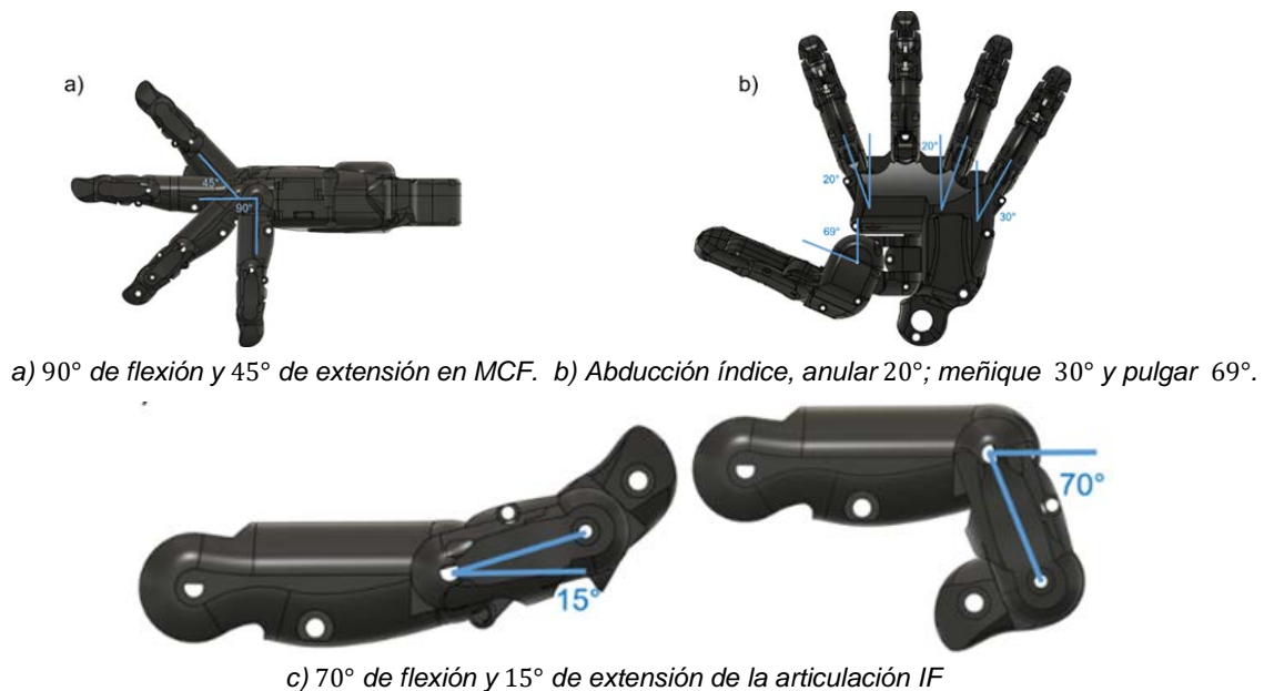
Figura 8 Posiciones del movimiento de los dedos de la mano robótica.
