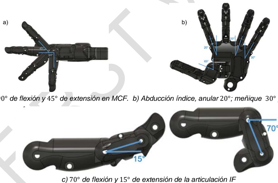
Figura 8 Posiciones del movimiento de los dedos de la mano robótica.
