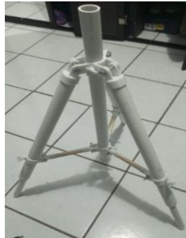
Figura 7 Trípode elaborado con PVC.
