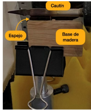
Figura 4 Vista trasera del espejo de prueba haciendo contacto con el cautín.
