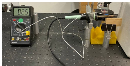
Figura 7 Medición de la temperatura del caudín con un termopar.
