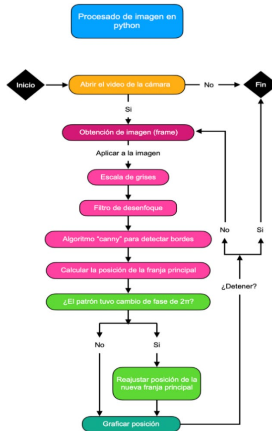
Figura 6 Pasos del algoritmo para procesar el patrón de interferencia.
