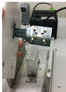
Figura 8 Soporte de portamuestra con sus puntas de contacto.
