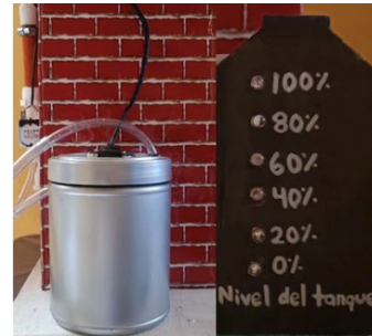
b) Tanque de almacenamiento e indicador de nivel.
