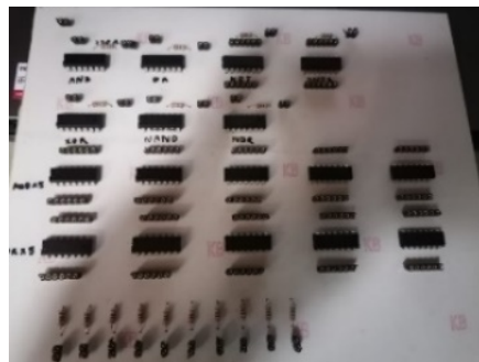
Figura 2 Placa construida con la distribución óptima de los circuitos integrados.
