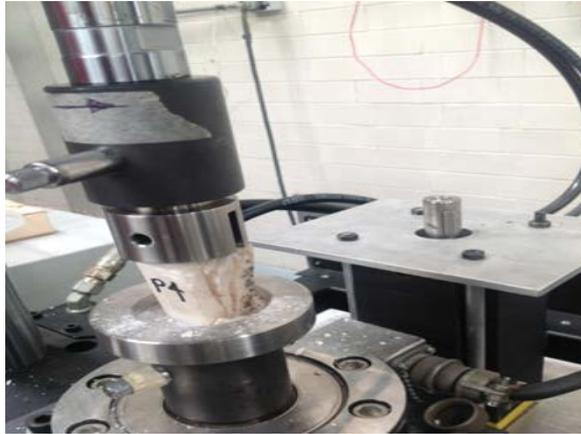
**Fig. 10. Agrietamiento y reacomodo de la probeta.**
