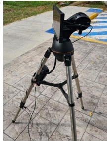
Figura 3 Adaptación del panel solar Duralast a la montura NexStar 130 SLT Celestron.
