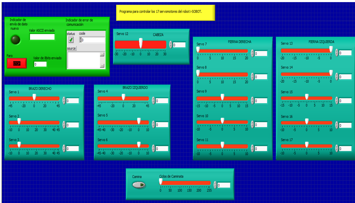
Fig. 8. Panel frontal del programa para controlar los 17 servomotores.
