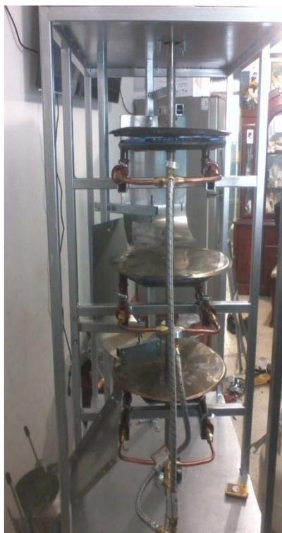
**Fig. 7. Máquina tortilladora de comales giratorios.**
