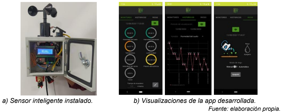
Figura 3 Estación meteorológica y aplicación desarrollada.
