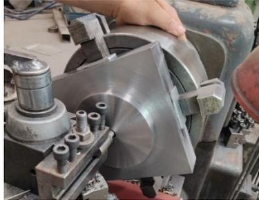
Figura 5 Maquinado de base centradora.
