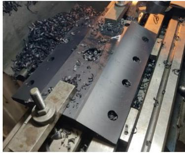
Figura 7 Fabricación base de báscula.
