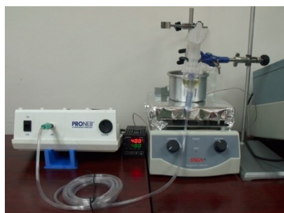
Figura 3 Sistema de microaspersión utilizado para incorporar nanopartículas.
