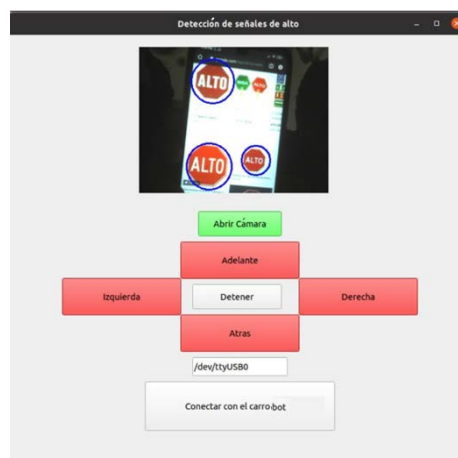
Figura 6 Interfaz gráfica para la conducción remota del prototipo carrobot.
