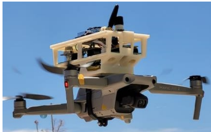
Figura 13 Sistema de medición montado sobre el dron en pleno vuelo.
