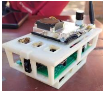
Figura 11 Montaje del sistema sobre la carcasa impresa en 3D.
